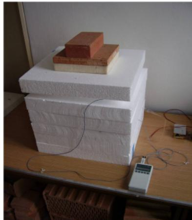
Zjišťování tepelné vodivosti a kapacity pomocí topného válce:
